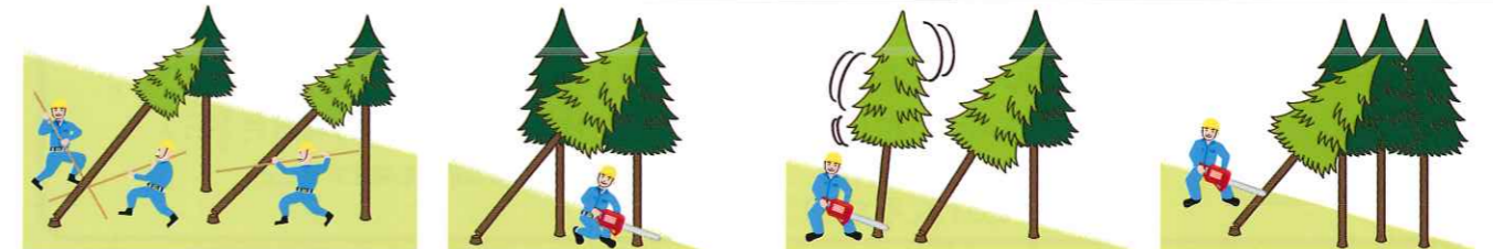
(図2)かかり木の処理 (図3)かかっている立木の伐倒 (図4)かかり木に激突させるためにかかり木以外の立木の伐倒 (図5)かかっている木の元玉切り
