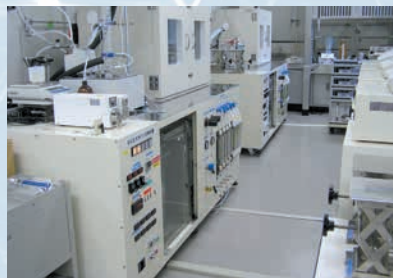
マスクの除毒能力試験装置 Mask gas-proof performance test apparatus
