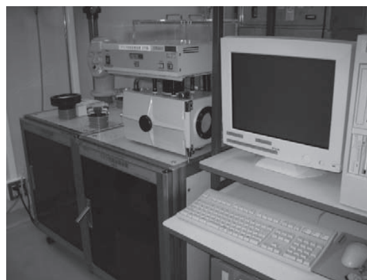
写真2 (公社)産業安全技術協会に設置された2種類の防じんマスクの捕集効率試験装置 上: DOP粒子の捕集効率試験用 下: 塩化ナトリウム粒子の捕集効率試験用
