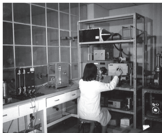
写真1 (独)産業医学総合研究所のダストチャンバーと防じんマスクの捕集効率試験装置
