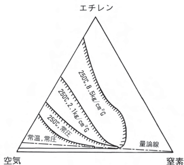
図4 エチレン・空気・窒素3成分系における爆発限界に対する温度・圧力の影響
