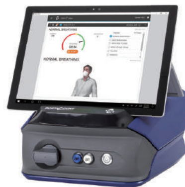
短縮定量的フィットテストに対応した TSI社製PORTACOUNT8048を使用
